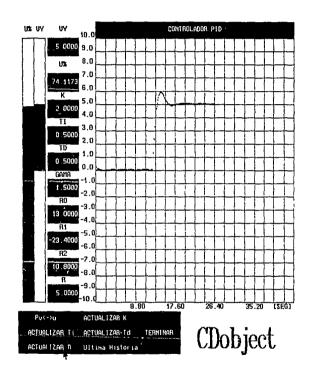
FIGURA V. 4 Corrida del controlador PID
