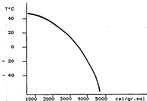
FIGURA II.11. Calor de vaporización del SF6 en función a la temperatura.
