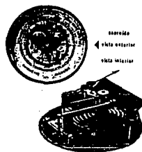
FIGURA IV-5 Barómetro Aneróide y su mecanismo.
