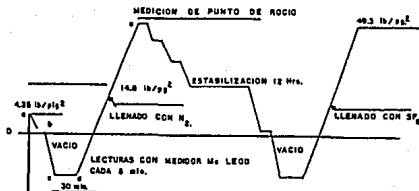
FIGURA IV-12 Gráfica guía para el proceso de vacío y llenado.
