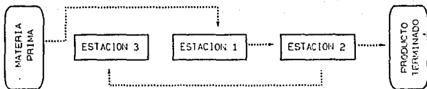
Figura 1.4 Ejemplo de lay-out deficiente:
