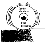
FIGURA 2.3 METODO DE COMPACTACION "VIBRACION"
