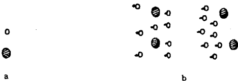
Fig.17. a) tamaños correspondientes a los átomos excitados y en estado base; b) posición espacial correspondiente de las moléculas después de la excitación y de unas pocas colisiones.
