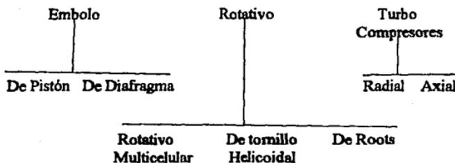
Fig. 2.1 Clasificación de los compresores
