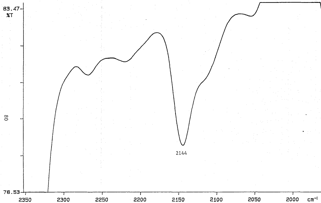
Figura 23. Espectro de Infrarrojo, región de 2350-2000 \text{cm}^{-1} , del Poli-DEOD.
