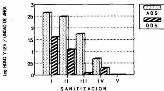
EFFECTO DE SANITIZACION EN CTA DE HONGOS Y LEVADURAS EN TOLVA DE ENVASE SIG 1
