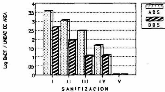
EFECTO DE SANITIZACION EN CTA. AEROBICA TOTAL DE TANQUES DE COCIMIENTO
