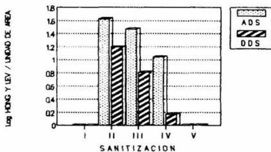
EFFECTO DE SANITIZACION EN CTA DE HONGOS Y LEVADURAS EN TOLVA DE HAR. IZQUIERDA
