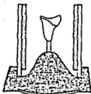
Una vez que se obtiene el patrón de cera, se une a él un cuele para colado y se recubre con revestimiento el cual se mezcla de la misma manera que el yeso piedra, se coloca alrededor del patrón y se deja fraguar. Después que endurece se retira el cuele, al igual que la cera, y se hace entrar el metal fundido dentro de la cavidad del molde que deja la cera, a través del bebedero o conducto formado por el cuele.
