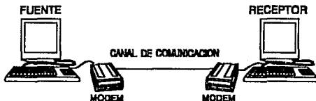
Figura 1.6 Realización de un enlace punto a punto
