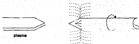
Fig. 1.7 Proceso del electrodo rotatorio.[5]
