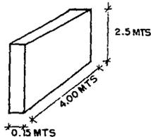
MURO DE CONCRETO ARMADO
