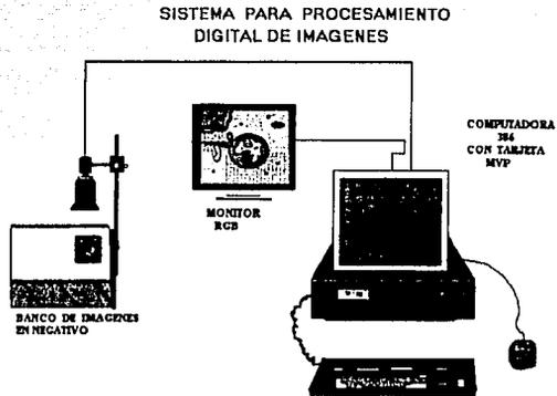
Figura 3.1 Equipo utilizado en el laboratorio de PDI del CIUNAM para la adquisición y procesamiento de imágenes.
