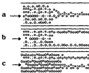
FIGURA 1.6 DIFERENTES FENOMENOS DE MIGRACION RADIAL. a) ACUMULACION CERCA DEL CENTRO DE LA TUBERIA, PARA ESFERAS FLEXIBLES, b) ACUMULACION CERCA DE LAS PAREDES, c) FORMACION DE UN ANILLO, DEBIDO A LA MIGRACION HACIA LAS PAREDES Y HACIA EL CENTRO DE LA TUBERIA.
