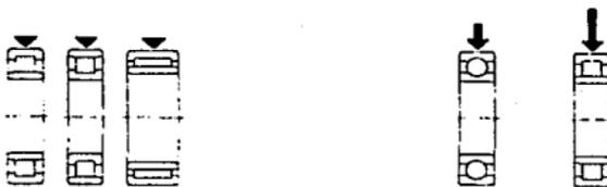
El tipo de rodamiento seleccionado es el rígido, de una hilera de bola con placa(s) de protección, número 6218-1Z, el cual tiene un diámetro interior de 90 mm, diámetro
