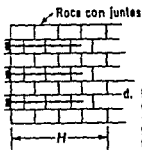
d. Pernos para roca que impiden el movimiento de los bloques en las jun- tas, formándose un muro
