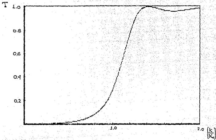
Gráfica 1. Coeficiente de Transmisión  $T$ , para una barrera rectangular de ancho  $a$ , y altura  $V_0 = \hbar^2 K_0^2 / 2m$  como función del vector de onda  $k = \sqrt{(2mE/\hbar^2)}$ , para  $aK_0 = \pi$ .
