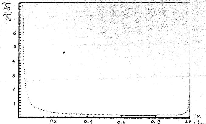
Gráfica 8. Tiempo fase (phase time) para una barrera opaca ( $aq \gg 1$ );  $a = 500 \text{ \AA}$ ,  $V_0 = 0.222 \text{ eV}$ , como función de  $k/K_0$ . ( $aK_0 = 10 \cdot \pi$ )
