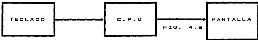
DIAGRAMA A BLOQUES DE UNA COMPUTADORA NORMAL
