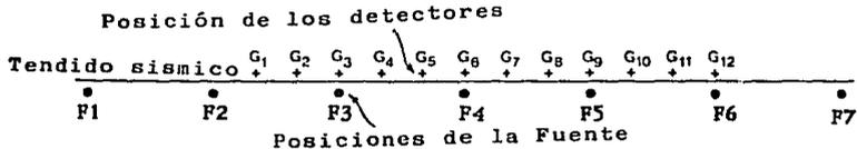
FIGURA II.3.1. Disposición de los detectores y de la fuente sísmica en un tendido sísmico.
