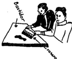
( bastidor o cernedor ) de modo que las mallas correspondientes a los detalles del dibujo queden libres, mientras que las restantes se obturan con cola. Para efectuar la impresión se aplica la tela sobre la superficie que se a de decorar y se vierte la tinta en el bastidor, la cual, al ser extendida, pasa por las mallas y queda aplicada en el objeto.
