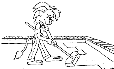
Fig. 4.2 Aplicación del impermeabilizante
