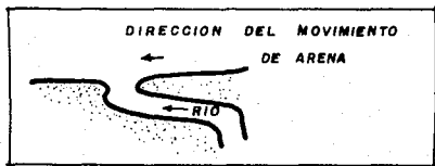
FIGURA IX-14. DESVIACION DE LA BOCA DE UN RIO POR LA ACCION DEL TRANSPORTE LITORAL
