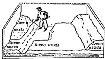
FIG 14 Reareno de un filtro lento en arena
