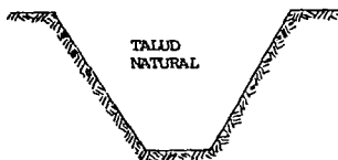
FIG. III.6 SE CONSERVA EL TALUD NATURAL
