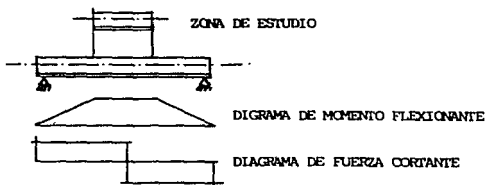
FIG. IV.8 ESPECIMEN TIPO PARA ESTUDIO DE FLEXION SIMPLE.
