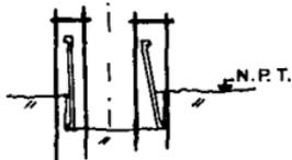
FIG. VIII b COLOCACION DE CIMBRA METALICA EN GUARNICION
