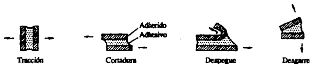
FIG. 1.8 Tensiones posibles sobre una unión con adhesivo
