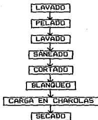
FIGURA 7. Pretratamiento de la zanahoria para el secado (13).
