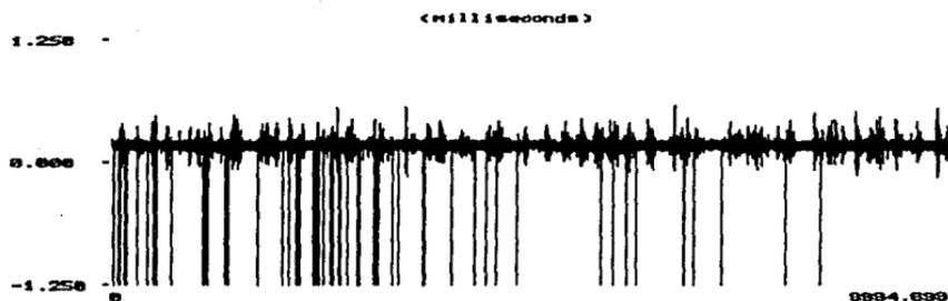
Figura 9. Ruido aleatorio de la señal producido por el estado de la cinta.
