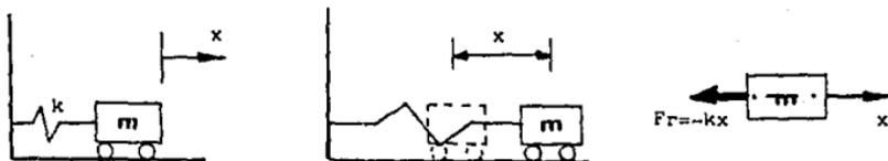
fig. 2.8 Sistema de un grado de libertad sin amortiguamiento
