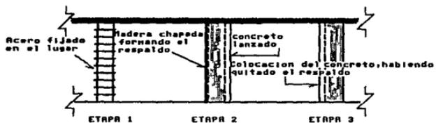
fig. 5.6 CONSTRUCCION DE MUROS DE CARGA Y COLUMNAS ENTRE PISOS Y TECHOS EXISTENTES.
