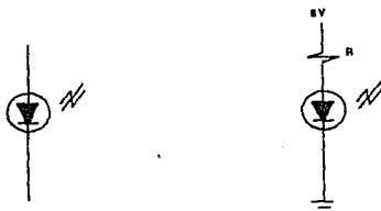
Figura 4.15. Símbolo del diodo emisor de luz.
