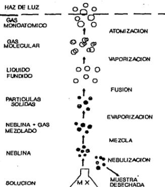
Figura 3. Proceso de atomización de la llama.
