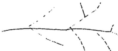
Debido a ésta estructura, los termoplásticos tienen uniones muy débiles y cuando se les aplica calor fluyen fácilmente.
