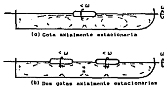
FIGURA 23. ONDAS DE FLUJO QUE PROVOCAN UNA DISMINUCION EN LA VELOCIDAD DE ROTACION EN GOTAS AXIALMENTE ESTACIONARIAS (42).
