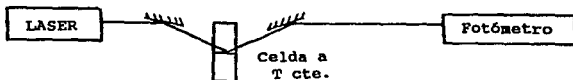
FIGURA 12. ESQUEMA DEL METODO DE DISPERSION LUMINOSA PARA MEDIR TENSIONES INTERFACIALES MUY BAJAS (31).
