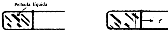
FIGURA 2. LA TENSION SUPERFICIAL ES LA MITAD DE LA FUERZA NECESARIA QUE, APLICADA UNA UNIDAD DE DISTANCIA SOBRE UNA PELICULA JABONOSA, PRODUCE UNA UNIDAD DE AREA SUPERFICIAL (10).
