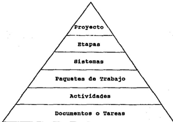
En el *Desglose de la Estructura de Trabajo* se definen las etapas, los sistemas, los paquetes de trabajo y las actividades del proyecto. En el formato FP-01 del anexo I, diseñado para este propósito, se desglosan todas las actividades del proyecto de DT para producir pirídina, clasificándolas según la siguiente estructura jerárquica:
