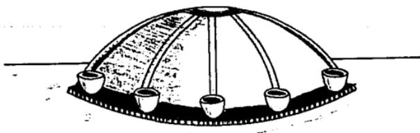
Figura 20. Sismoscopio ideado por De Haute Feuille.
