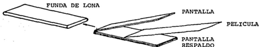
FIGURA 6.5.- COMPONENTES DE UN CHASIS.
