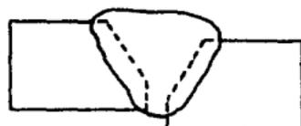
FIGURA 10.12.-a) FALTA DE PENETRACION OCASIONADA POR DESA LINEAMIENTO.
