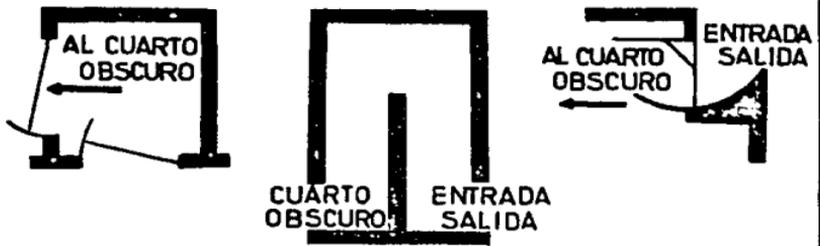
FIGURA 7.2.-TIPOS DE ENTRADAS A CUARTOS OSCUROS.
