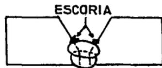
FIGURA 10.6.-PROPORCIONARA UNA IMAGEN RADIOGRAFICA DONDE SI SE NOTARA EL CORDON DE FONDEO.
