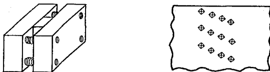
Figura 2.4 a) portamuestras utilizado para la preparación metalográfica y b) representación esquemática de los perfiles de microdureza.
