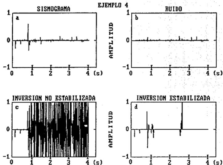
**FIGURA 4.-EJEMPLO EN EL QUE SE MUESTRA LA INVERSION EN SISMOGRAMAS CON NIVEL ALTO DE RUIDO, MEDIANTE DECONVOLUCION DINAMICA**
