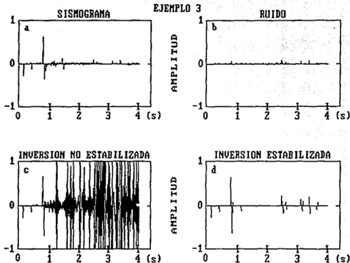
FIGURA 3 -EJEMPLO EN EL QUE SE MUESTRA LA INVERSION EN SISMOGRAMAS CON NIVEL MEDIO DE RUIDO, MEDIANTE DECONVOLUCION DINAMICA
