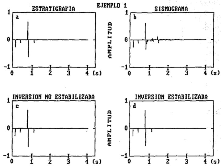
FIGURA 1.-EJEMPLO EN EL QUE SE MUESTRA LA INVERSION EN SISMOGRAMAS SIN RUIDO, MEDIANTE DECONVULSION DINAMICA
