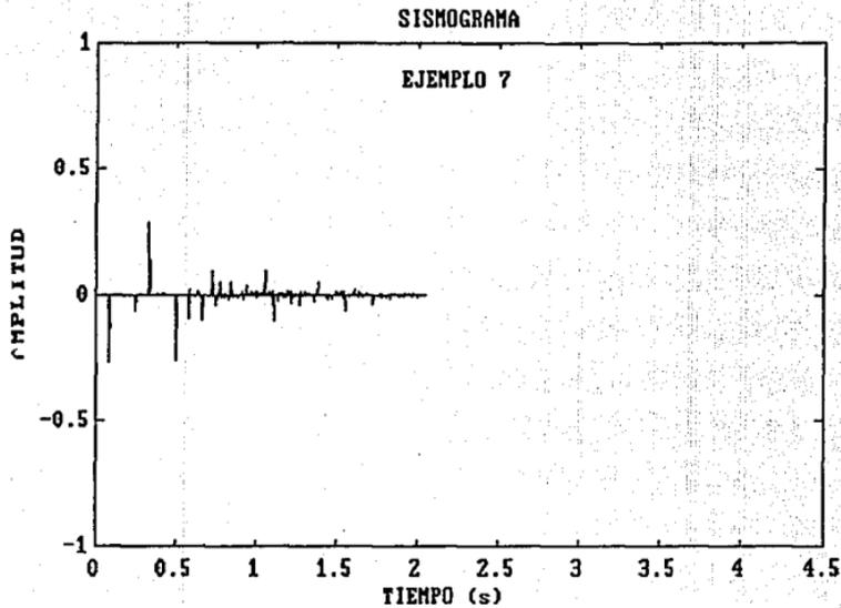
FIGURA 8.- SISMOGRAMA PARA INVERSION CON UN NIVEL MEDIO DE RUIDO
