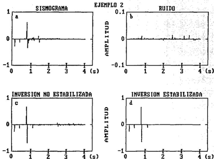
FIGURA 2.-EJEMPLO EN EL QUE SE MUESTRA LA INVERSION EN SISMOGRAMAS CON NIVEL BAJO DE RUIDO, MEDIANTE DECONVOLUCION DINAMICA
