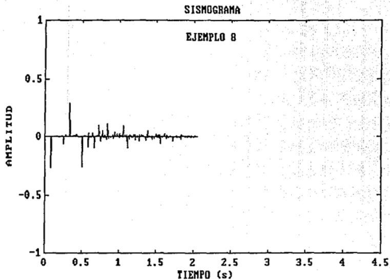
FIGURA 10.- SISMOGRAMA PARA INVERSION CON UN NIVEL ALTO DE RUIDO
