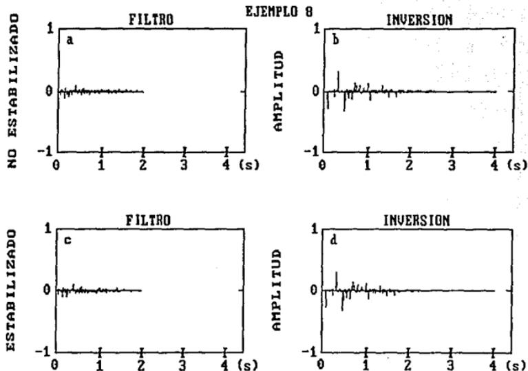
FIGURA 11.-EJEMPLO EN EL QUE SE MUESTRA LA INVERSION EN SISMOGRAMAS CON UN NIVEL ALTO DE RUIDO, MEDIANTE FILTRO INVERSO
