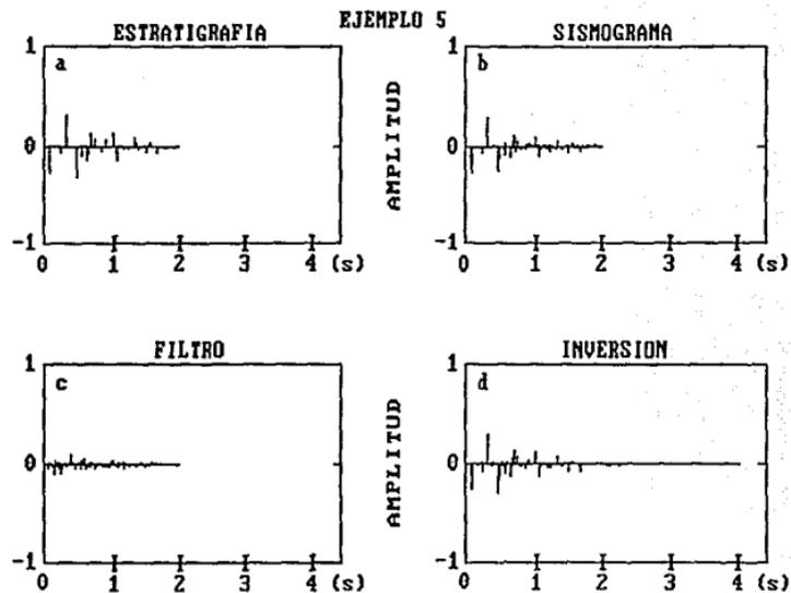
**FIGURA 5.-EJEMPLO EN EL QUE SE MUESTRA LA INVERSION EN SISMOGRAMAS SIN RUIDO, MEDIANTE FILTRO INVERSO**
