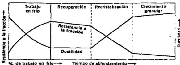
Fig. 4 .- Resistencia a la tracción y ductilidad de un metal en función del porcentaje de trabajo en frío y tiempo de ablandamiento. La resistencia a la tracción aumenta y la ductilidad disminuye durante el trabajo en frío. Estas propiedades se modifican durante la recuperación. Durante la recristalización, la resistencia a la tracción disminuye y la ductilidad aumenta rápidamente. Durante el crecimiento granular, sólo se producen cambios leves.
