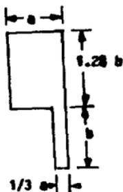
Fig. 3.23 Dimensiones recomendadas para el diseño de la válvula deslizable.
