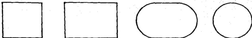
Fig 3.17 Diferentes tipos de secciones de los puertos de entrada
