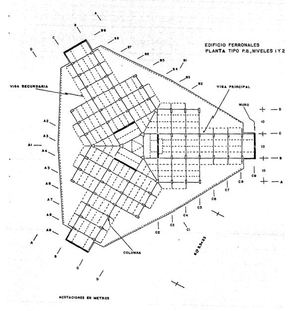
fig 4.2 Planta tipo en planta baja y los primeros dos niveles. Edificio Ferronales.
