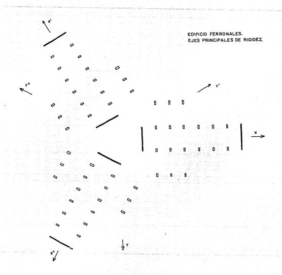
fig 4.11 Ejes principales de rigidez en el edificio Ferronales.
