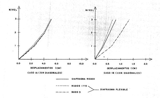
fig 3.2 Desplazamientos CASO 1, sin diagonales y con diagonales en los extremos (casos 1A y 1B).
