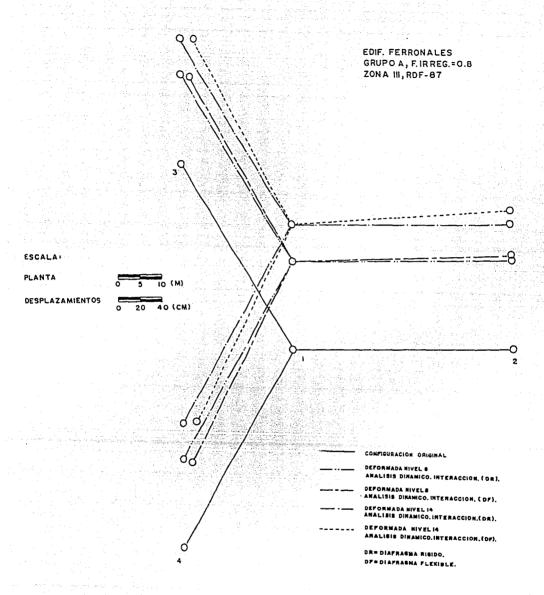
fig 4.18 Deformadas de los niveles 14 y 8, cuando el sismo actúa en la dirección "Y". Edificio Ferronales.
