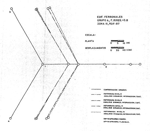
fig 4.19 Deformadas de los niveles 14 y 8, cuando el sismo actúa en la dirección "X". Edificio Ferronales.
