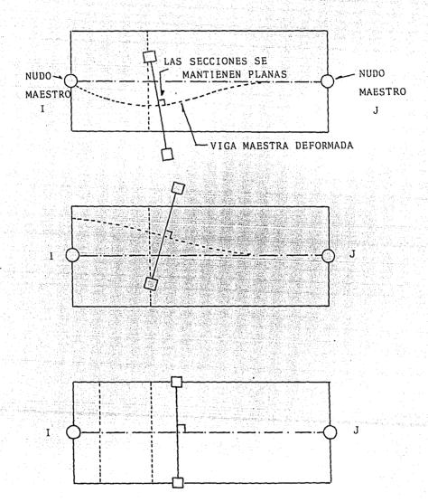
fig 2.7 Desplazamientos típicos de una viga de piso.
