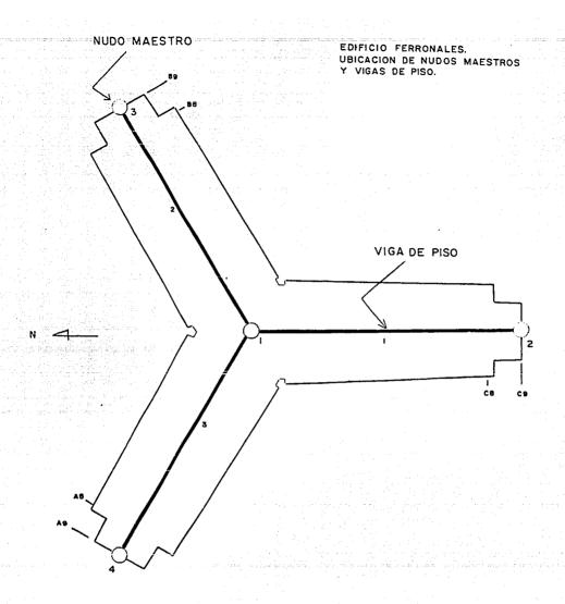
fig 4.10 Ubicación de los nudos maestros y vigas de piso en el modelo con diafragma flexible. Edificio Ferronales.
