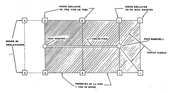
fig 2.4 Tipos de nudos en una planta típica.
