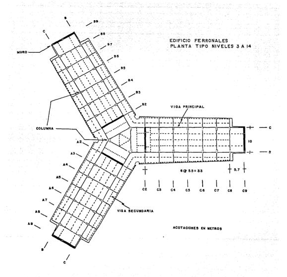
fig 4.3 Planta tipo niveles 3 a 14. Edificio Ferronales.
