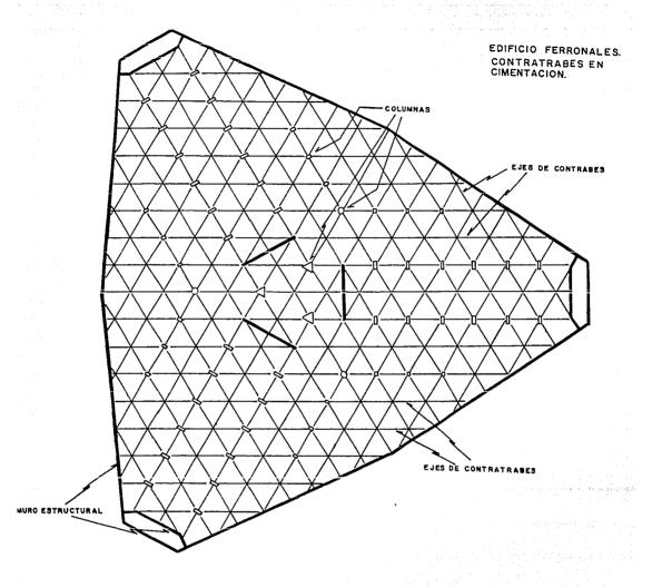
fig 4.6 Retícula de contratrabes en la cimentación. Edificio Ferronales.
