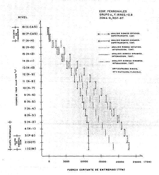
fig 4.16 Fuerzas cortantes de entrepiso. Diafragma rígido (sismo en "X" o en "Y") y diafragma flexible (sismo en "Y"). Edificio Ferronales.
