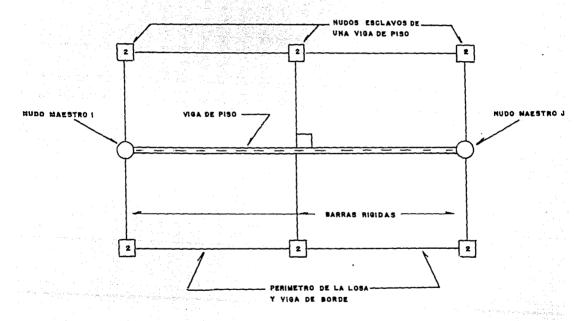
fig 2.6 Planta flexible y relación entre nudos maestros, vigas de piso y nudos esclavos.
