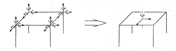
fig 2.1 Simplificación del modelo matemático, considerando el sistema de piso infinitamente rígido.
