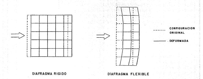
fig 2.3 Comportamiento del sistema de piso como un diafragma infinitamente rígido ycomo un diafragma flexible.
