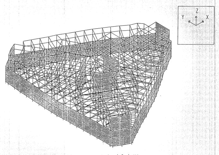
fig 4.9 Vista del modelo matemático de los niveles inferiores.
