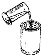
Fig.4.13 Llenado del filtro con combustible limpio.
