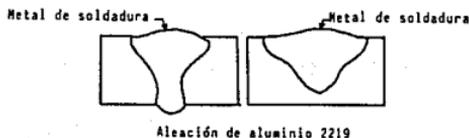
**Fig. 7.4.11.** Efecto de variar la distancia de trabajo, dentro de límites prácticos de operación, en soldadura por rayo de electrones sin vacío de aleación de aluminio 2219 de 1/4 de pulg. de grueso.
