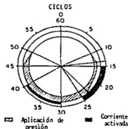
Fig. 6.1.3 Ciclo típico de corriente y presión para puntear. El ciclo incluye forjado y postcalentamiento.
