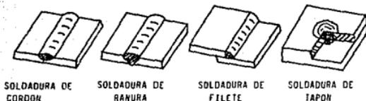
Las soldaduras de cordón no requieren preparación de - las orillas. Sin embargo, como la soldadura se realiza sobre una superficie plana y, por lo tanto, su penetración es limitada, estas soldaduras son adecuadas sólo para unir láminas - delgadas de metal, para reconstruir superficies o para apli- - car metales de recubrimiento duro.
