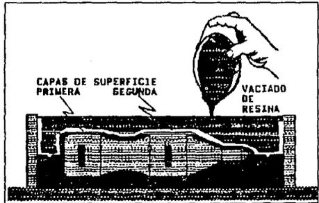
30)+ Aplique la segunda capa de superficie con el correspondiente vaciado de material segun las indicaciones dadas en los incisos 14 y 15.
