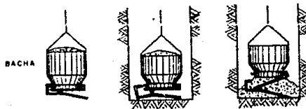
Fig. 4.37.-FUNCIONAMIENTO DE UNA BACHA
