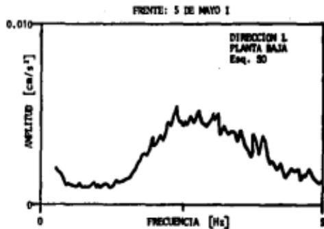
Fig 8. Espectros de potencia obtenidos en los edificios desplantados sobre suelo blando
