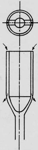
FIG.12 CELDA DE MEDICION DE CONDUCTIVIDAD.
