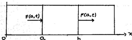
Esto puede ser relacionado a la función temperatura, utilizando la ley física empírica, la cual establece que el flujo de calor en un punto cualquiera es proporcional al gradiente de temperatura en ese punto; su representación es :
