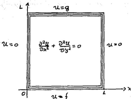
La interpretación física del problema indica que las condiciones - auxiliares son apropiadas para la ecuación diferencial (27): Estos es, que para  $f(x)$  y  $g(x)$  arbitrarias hay solamente una solución - para la ecuación diferencial que satisface las condiciones auxiliares.
