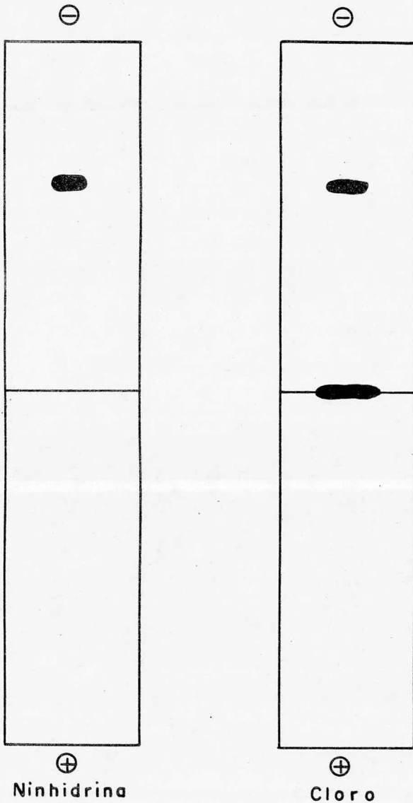
Figura ( 17 ).- Electroforesis analítica a pH 1.8 del extracto obtenido a pH 10.0. Tiras de papel Whatman de 6 x 31 cm; 450 v; 80 min; amortiguador: ác. fórmico : ác. acético glacial : agua, (1:4:45, v/v/v).
